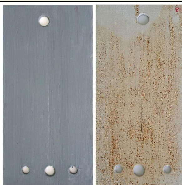
Após 24 h em atmosfera marinha + NaCl 3,5 %
