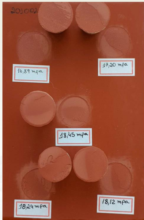
Fig. 7 - Teste de tração por pull-off de revestimento epóxi sobre (a) Sa 2½ e (b) flash rust
