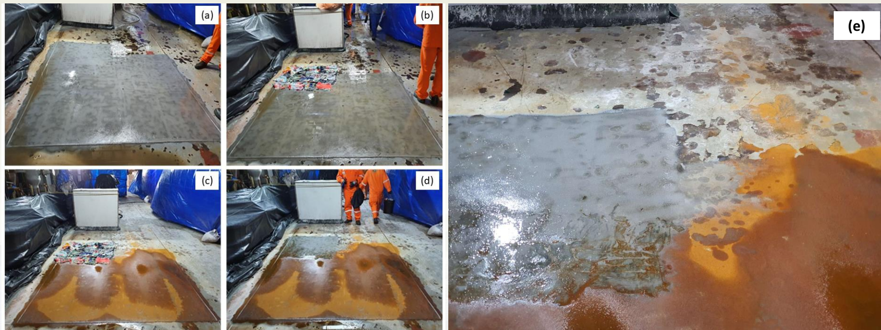
Fig. 22 - Teste de campo em parte de piso preparado por JAU. Trapos enxarcados com inibidor.
