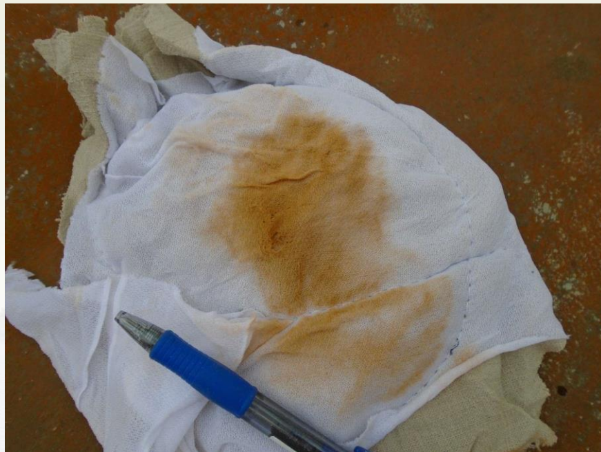
Fig. 6 - (a) Teste qualitativo de classificação do grau de flash rust e (b) pintura sobre flash rust
