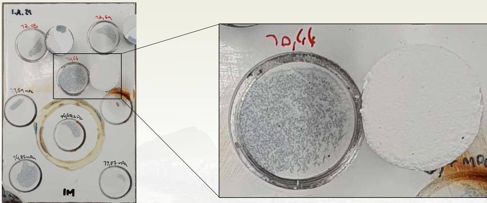
Fig. 23 - Teste de tração por pull-off de revestimento epóxi (N-2943) sobre Sa 2½ com inibidor de flash rust .
